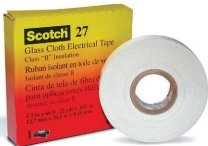
Es una cinta de tela de fibra de vidrio diseñada para aplicaciones que requieran alta resistencia mecánica y resistencia a temperaturas elevadas. El tejido de fibra de vidrio esta especialmente tratado para dar una protección anticorrosiva. Su adhesivo sensitivo a la presión es termocurable, lo que garantiza la duración de la aplicación. Esta considerada como clase B, por lo que puede trabajar a 150° C continuos.
